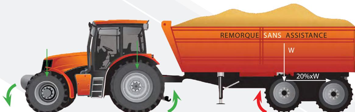
Les tests réalisés montrent qu'un tracteur de 350ch associé à une remorque de 30T équipée de moteurs Black Bruin roulant à vitesse constante réduit sa consommation de carburant de 15%.
